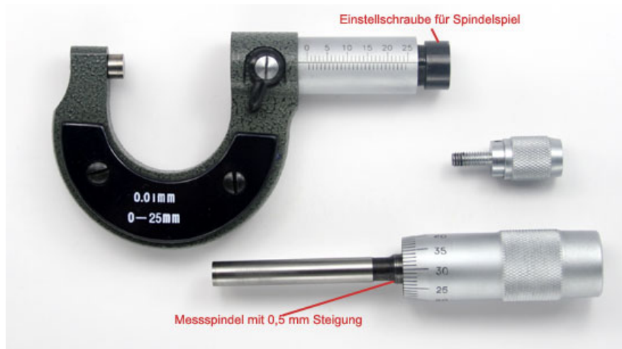
Abbildung 7: Zerlegte Messschraube mit Markierungen der Einstellschraube und Messspindel.
