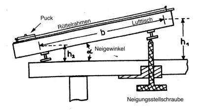
**Abbildung 3.2:** Schematische Darstellung des Versuchsaufbaus. (Seitenansicht)
