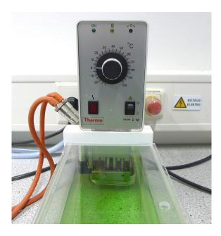
Abbildung 3: Foto des Thermostatreglers mit integrierter Umwälzpumpe (Schalter rechts) und elektrischer Heizung (rote Anzeige).
