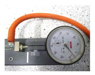
Abbildung 2: Mikrometer-Messuhr zur Bestimmung der Längenänderung des Stabes. Die kleinste Differenz zwischen zwei Skalierungsmarken beträgt  $10\,\mu m$ . Der obere Ring der Messuhr kann vorsichtig gedreht werden, um den Zeiger zu Beginn der Messung auf Null zu stellen.
