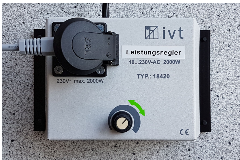
Abbildung 2: Foto des verwendeten Leistungsreglers. Der hier gezeigte grüne Doppelpfeil zeigt den Einstellbereich, welcher für ein leichtes Kochen des Wassers zu erwarten ist, ohne dass sprudelnd kochendes Wasser aus dem Behälter spritzt.
