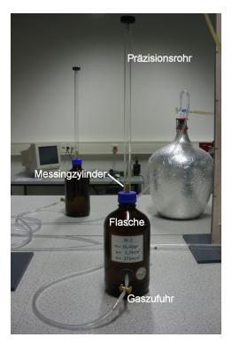
**Abbildung 3:** Foto des Versuchsaufbaus zur Bestimmung von  $\gamma$  nach E. Rüchardt.
