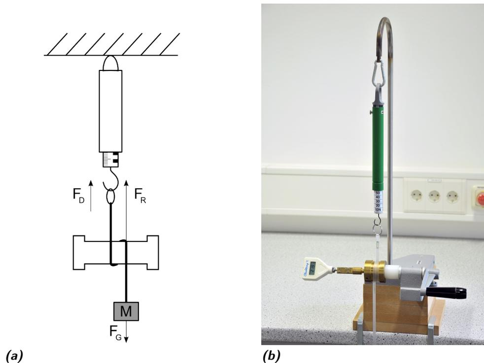
**Abbildung 3.1:** Schema (a) und Foto (b) des Versuchsaufbaus
