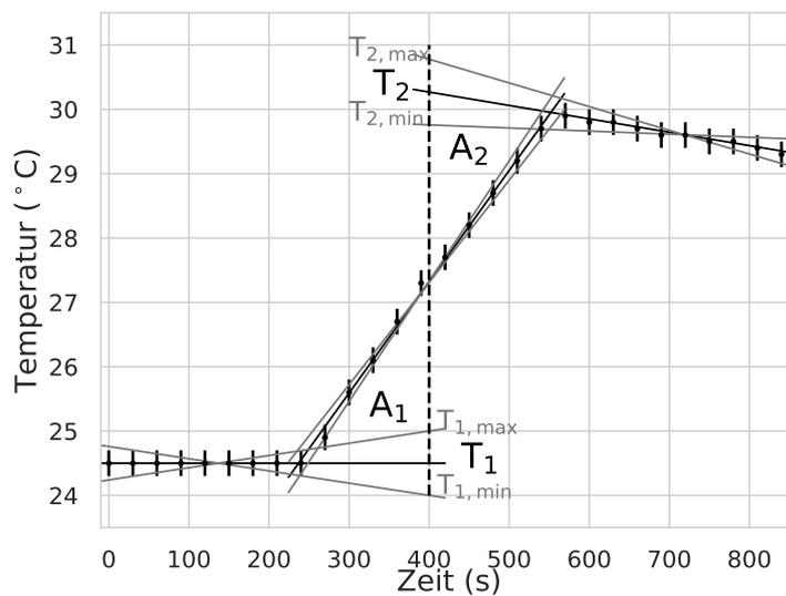
**Abbildung 6.1:** Exemplarisches Temperaturdiagramm mit graphischer Geradenanpassung
