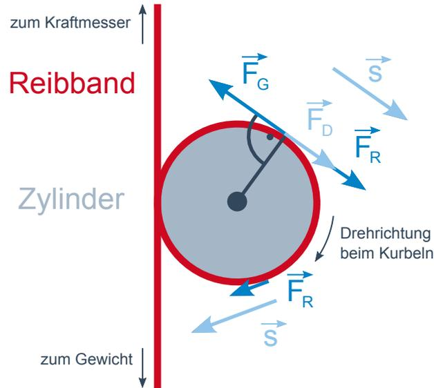
**Abbildung 7.1:** Kräftesituation am Zylinder. Es herrscht Kräftegleichgewicht, der Wegvektor  $\vec{s}$  ist immer parallel zur Reibungskraft  $\vec{F}_R$ .
