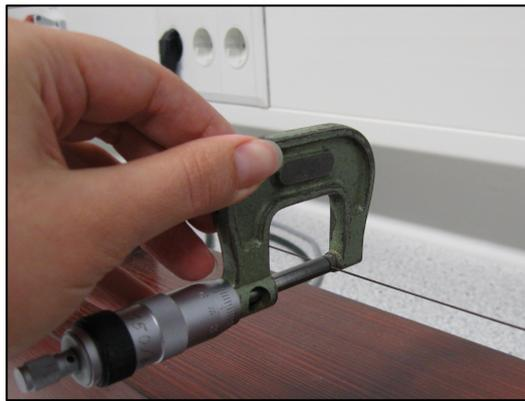
Abbildung 2: Mikrometerschraube
