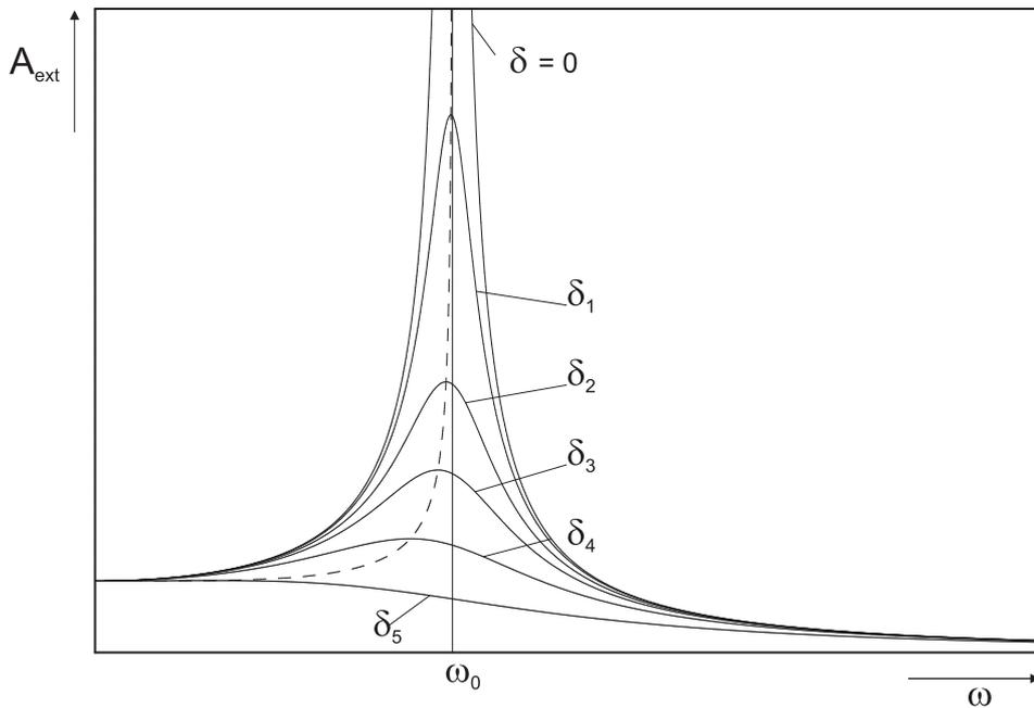
Abbildung 2: Abhängigkeit der Amplitude des Oszillators von der Frequenz der erzwungenen Schwingung. In der Abbildung gilt  $\delta_j > \delta_k$  für  $j > k$ . Die gestrichelte Kurve gibt die Lage der Maxima an.
